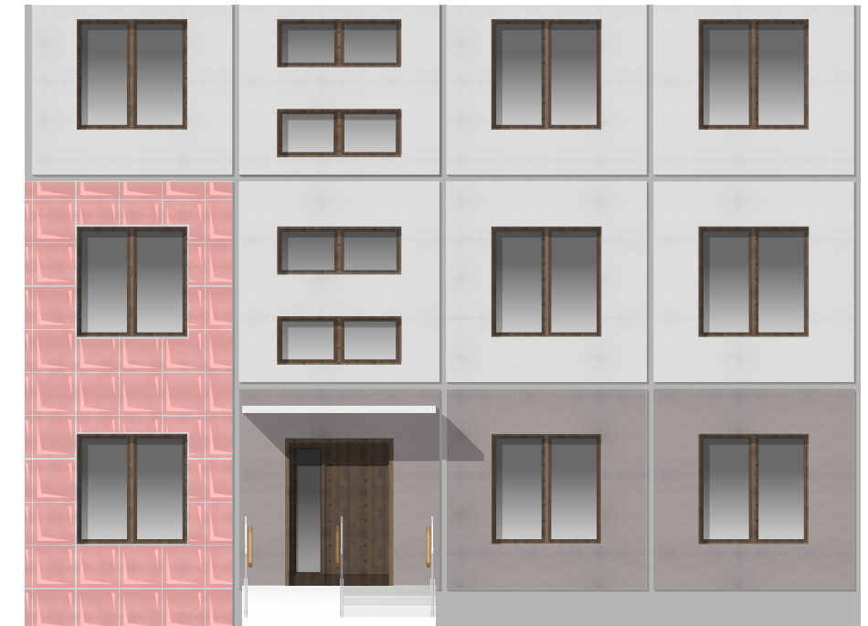
ПЛОХО. Фасад имеет фрагментарную отделку разными материалами
