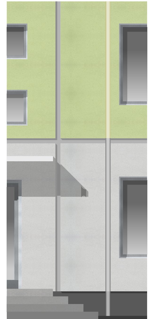
ХОРОШО. Водосточная труба соединена с ливневой канализацией
